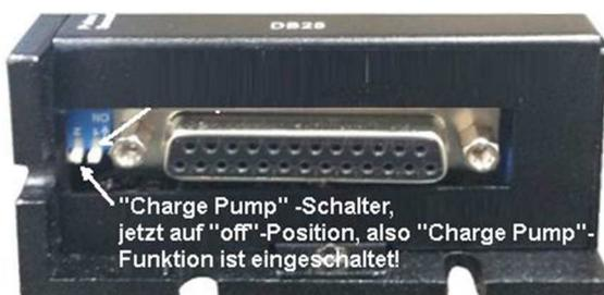
Um die Funktion für Controller, die kein 10 kHz –Signal liefern können, zu deaktivieren muss der Schalter auf „ON“ stehen.
